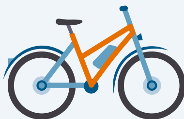
Cadre trapèze Bonne stabilité ; relativement facile à enfourcher
